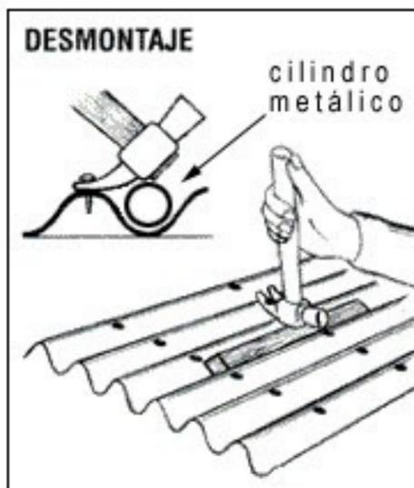
Para el eventual desmontaje de las placas, se sacan los clavos de fijación con un martillo ahorquillado, cuidando de hacer palanca sobre un cilindro metálico introducido en la cavidad de la onda.
